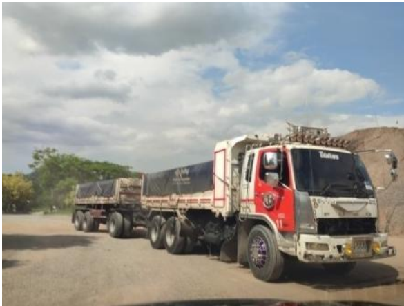
รูปที่ 2-9 ผ้าใบปิดคลุมกระบะบรรทุกให้มิดชิด
